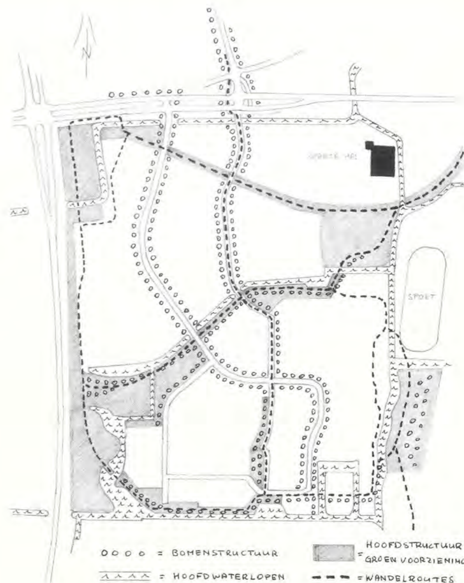
Op deze kaart zijn de bomenstructuur, de hoofdstructuur groenvoorziening, de hoofdwaterlopen en de wandelroutes aangegeven.
